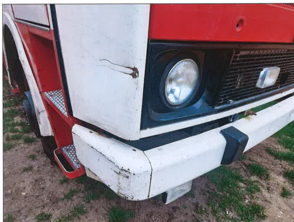
Korózia a poškodenia nadstavby a kabíny
