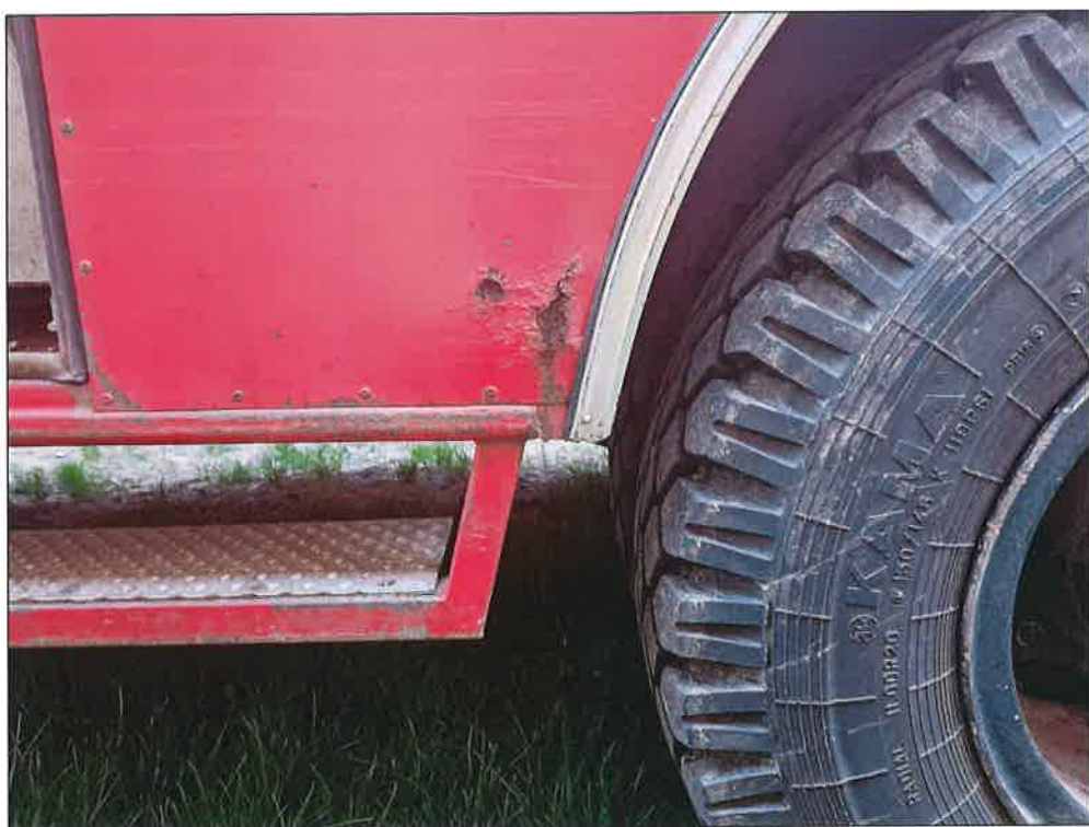
Korózia a poškodenia nadstavby
