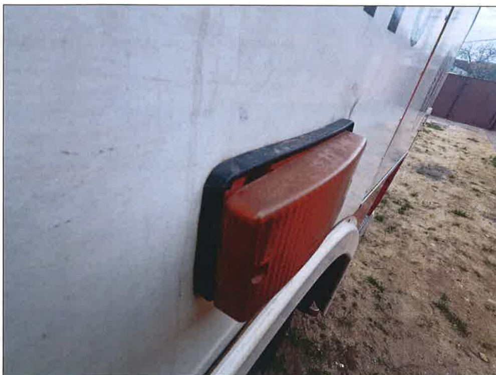
Poškodenie smerového svetidla
